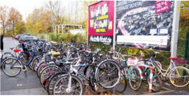
Felgenklemmer auf der Bahnhofssüdseite sind für Radfahrer nicht sehr attraktiv. Ein sicheres Abschließen ist hier nur schwer möglich.
