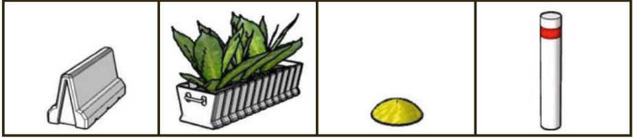
In der Studie genutzte Trennelemente. Von links nach rechts: Betonbarriere, Blumenkübel, Bodenschwelle, Flexibler Leitpfosten.
